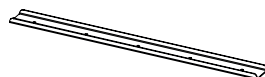
2 x N - 1 x perfil de refuerzo (si la distancia entre las pata de mesa es mayor que 2300 mm)
