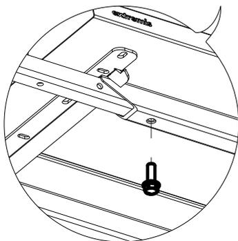
Fixez les deux profils de connexion sur le cadre du plateau. Utilisez les premiers trous des profils de connexion
