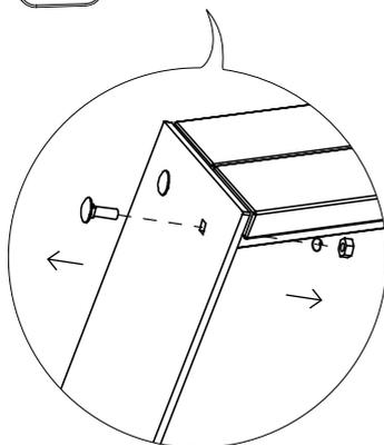
**Retirez ces boulons, écrous et rondelles élastiques sur l'extérieur du banc**
